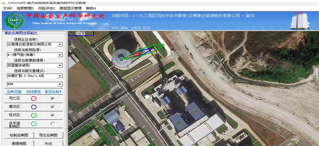
图 7-4 煤气柜（容器破裂）中毒事故影响图
