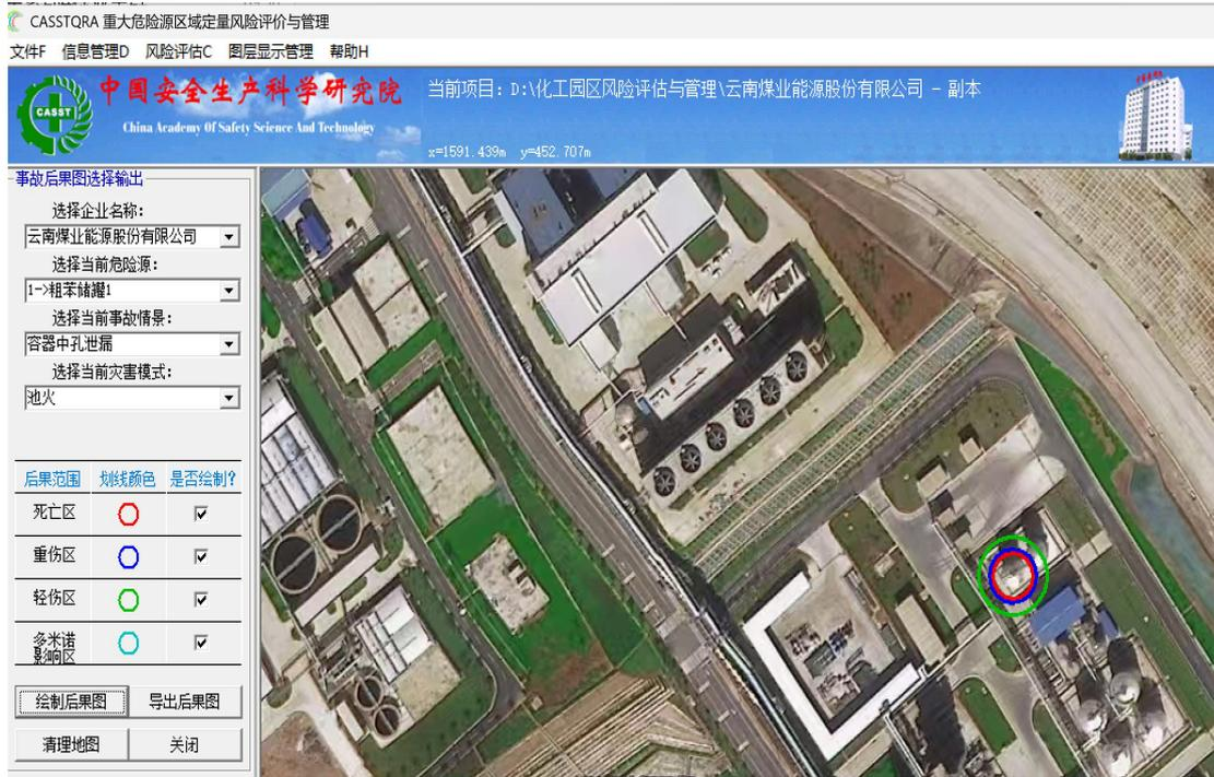
图 7-2 粗苯储罐（中孔泄漏）事故影响图
