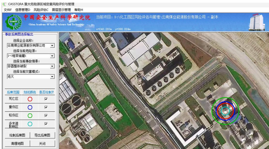
图 7-3 粗苯储罐（整体破裂）事故影响图
