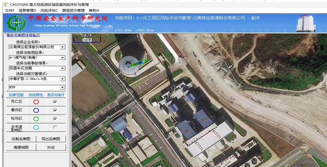
图 7-5 煤气柜（中孔泄漏）中毒事故影响图
